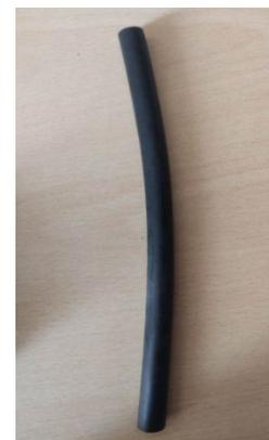
Figure 2. Membrane en néoprène
