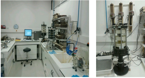
Figure 14. Dispositif de l'appareil triaxial cyclique utilisé.
