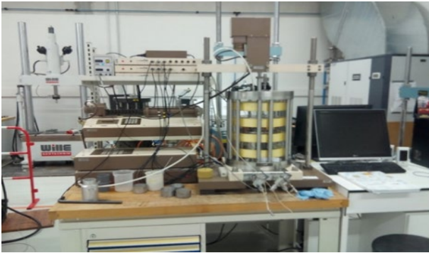
Figure 15. Appareillage de la colonne résonante utilisé.
