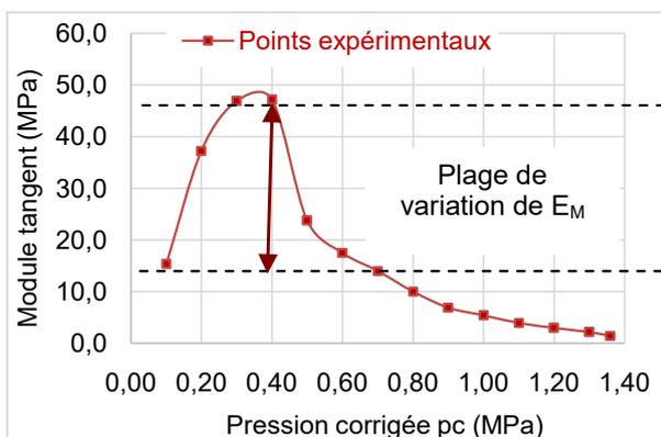
Figure 1.d : Courbes des modules tangents de l'essai
