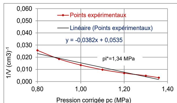
Figure 1.b : Courbe « inverse » de l'essai
