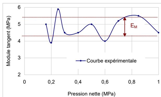
Figure 3.b : Courbe des modules tangents de l'essai
