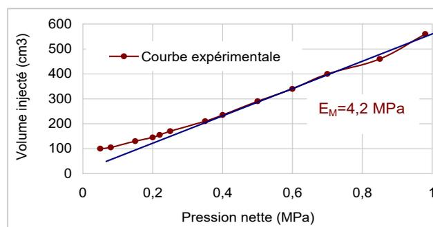
Figure 3.a : Courbe pressiométrique de l'essai
