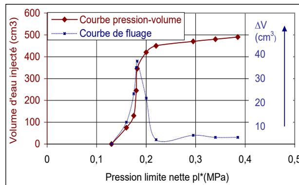
Figure 2 : Courbe type d'un essai « remanié » (essai écarté de l'analyse des fondations du projet)
