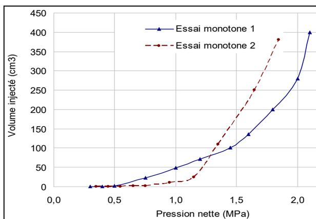
Figure 4.a : Courbe pressiométrique des 2 essais
