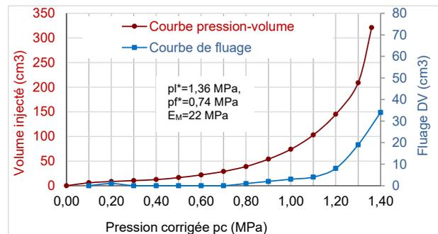
Figure 1.a : Courbe pression-volume de l'essai
