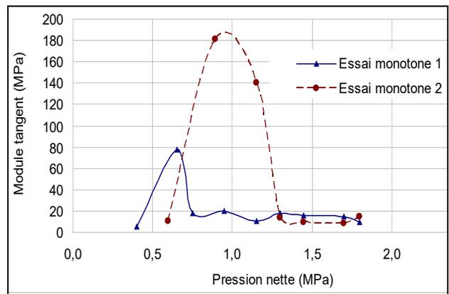
Figure 4.b : Courbe des modules tangents des 2 essais
