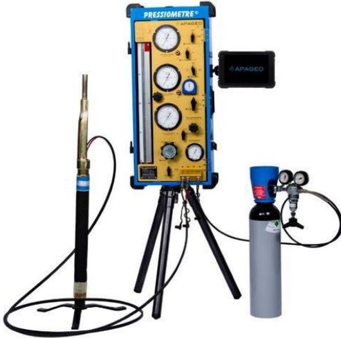
Fig. 1. Le pressiomètre Ménard avec enregistreur automatique des lectures
