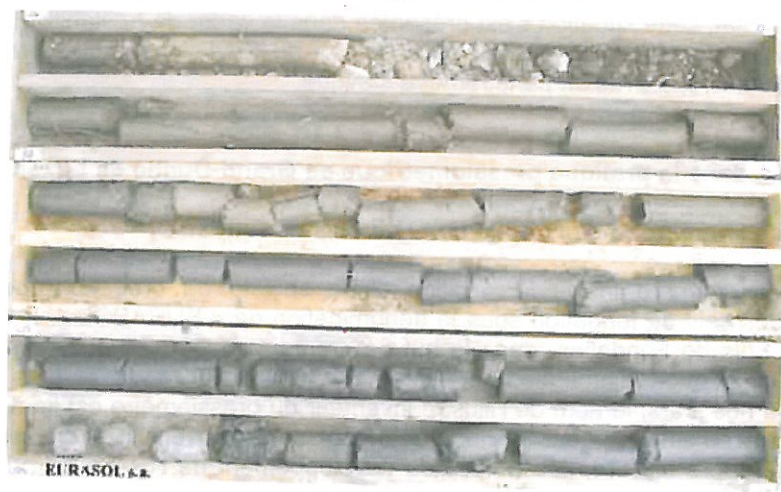
Figure 1. Carottes récupérées d'un forage pressiométrique étalées dans des caisses de 1 m à 2 compartiments; avant analyses des carottes, on reconnaît déjà nettement l'interface remblai/limon brun, ce dernier se transformant progressivement en marne altérée grise et marne gris noir feuilletée reposant sur du calcaire.
